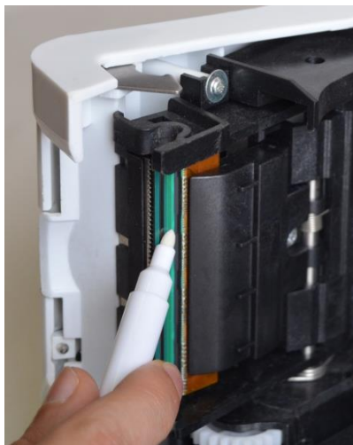
5. Удалите гарь с помощью спец. карандаша или спиртовой салфетки
